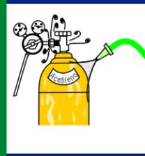
No abrir arco eléctrico utilizando el cilindro como encendedor, ni coloque el cilindro donde pueda hacer contacto eléctrico.
