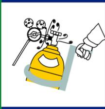
No use pinzas o llaves para abrir la válvula de un cilindro si esta muy apretada, sepárelo y llámenos
