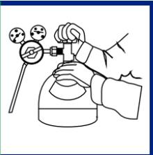
Revise posibles fugas de gas solo con espuma de agua y jabón.
