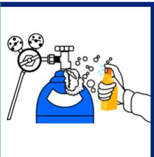
Desconectar un cilindro en operación es muy peligroso, ya que trabaja a alta presión, siempre cierre la válvula del cilindro y libere la presión del regulador antes de desconectar.
