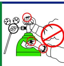
En caso de fuga o calentamiento de un cilindro de acetileno, rociar el cuerpo del cilindro con agua constantemente para enfriarlo y llame a su suplidor de gases.
