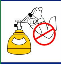
Cuando manipule cilindros de oxígeno, no use grasas, aceites o derivados de hidrocarburos ya que en contacto con el oxígeno, este puede reaccionar violentamente.
