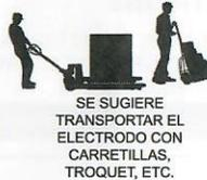
SE SUGIERE TRANSPORTAR EL ELECTRODO CON CARRETIILLAS, TROQUET, ETC.
