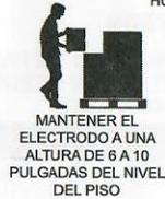
MANTENER EL ELECTRODO A UNA ALTURA DE 6 A 10 PULGADAS DEL NIVEL DEL PISO
